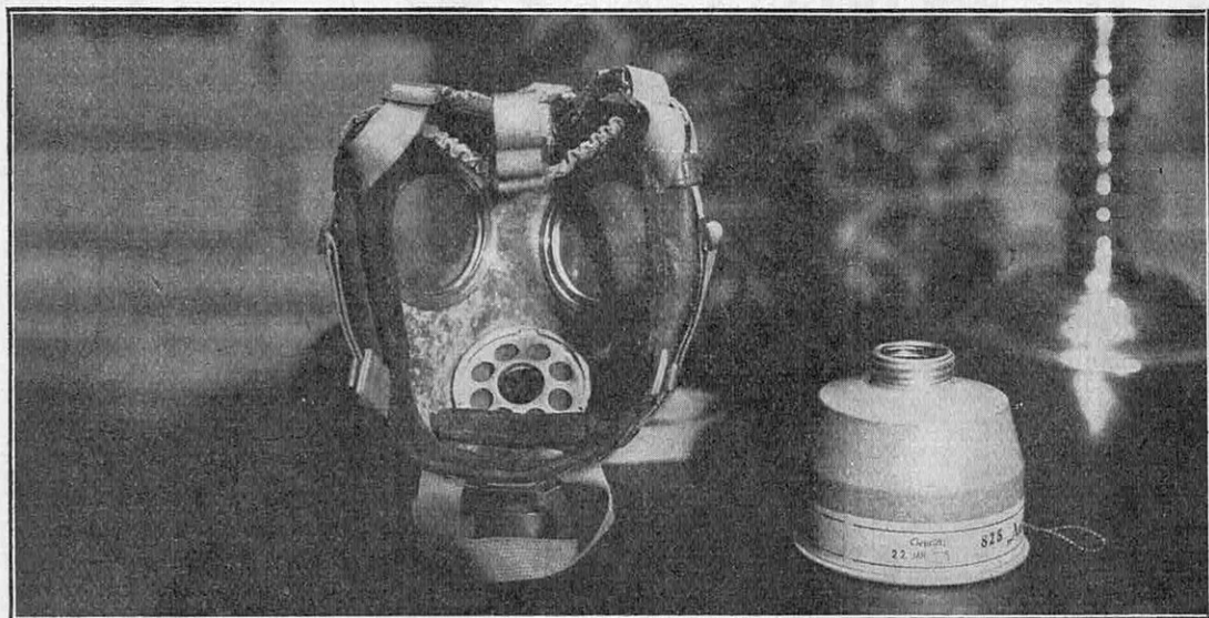
FIG. 2. - VOICI, DÉMONTÉ, LE MASQUE ALLEMAND REPRÉSENTÉ SUR LA FIGURE PRÉCÉDENTE. On remarquera, à gauche, l'épaisseur des bourrelets destinés à s'appliquer sur les joues, et qui assurent une étanchéité absolue. Sur la capsule, à droite, se trouve l'inscription Geprüft 22 jan. 1935 (vérifié le 22 janvier 1935), ce qui indique la date toute récente de cette fabrication.
