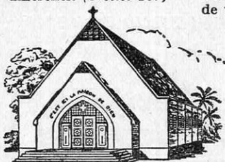
EGLISES ET TEMPLES COLONIAUX avec toiture en pente de 80 centimètres au mètre. (Notice 214)
