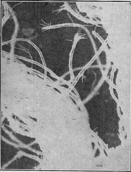
FIG. 8. — FIBRES DE LAINE ROMPUES
