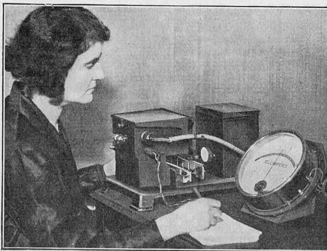
FIG. 4. — DÉTAIL DU PHOTOCOLORIMÈTRE (TOUSSAINT-PINTE) MONTRANT L'ESSENTIEL DE L'APPAREILLAGE
