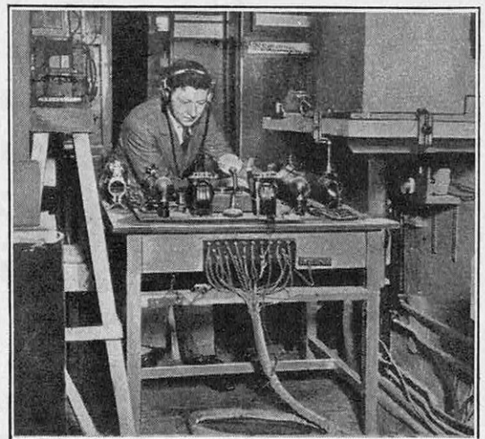
FIG. 7. — LE BOMBARDEMENT DU LITHIUM A L'AIDE DE PROTONS ACCÉLÉRÉS
