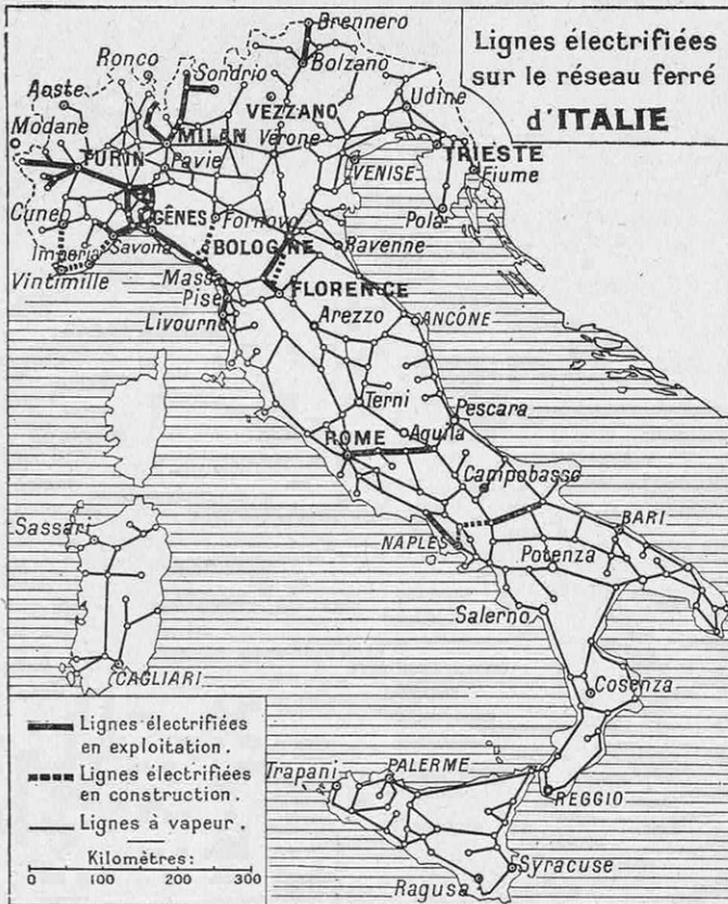
FIG. 5. — LE RÉSEAU FERRÉ ÉLECTRIQUE ITALIEN
