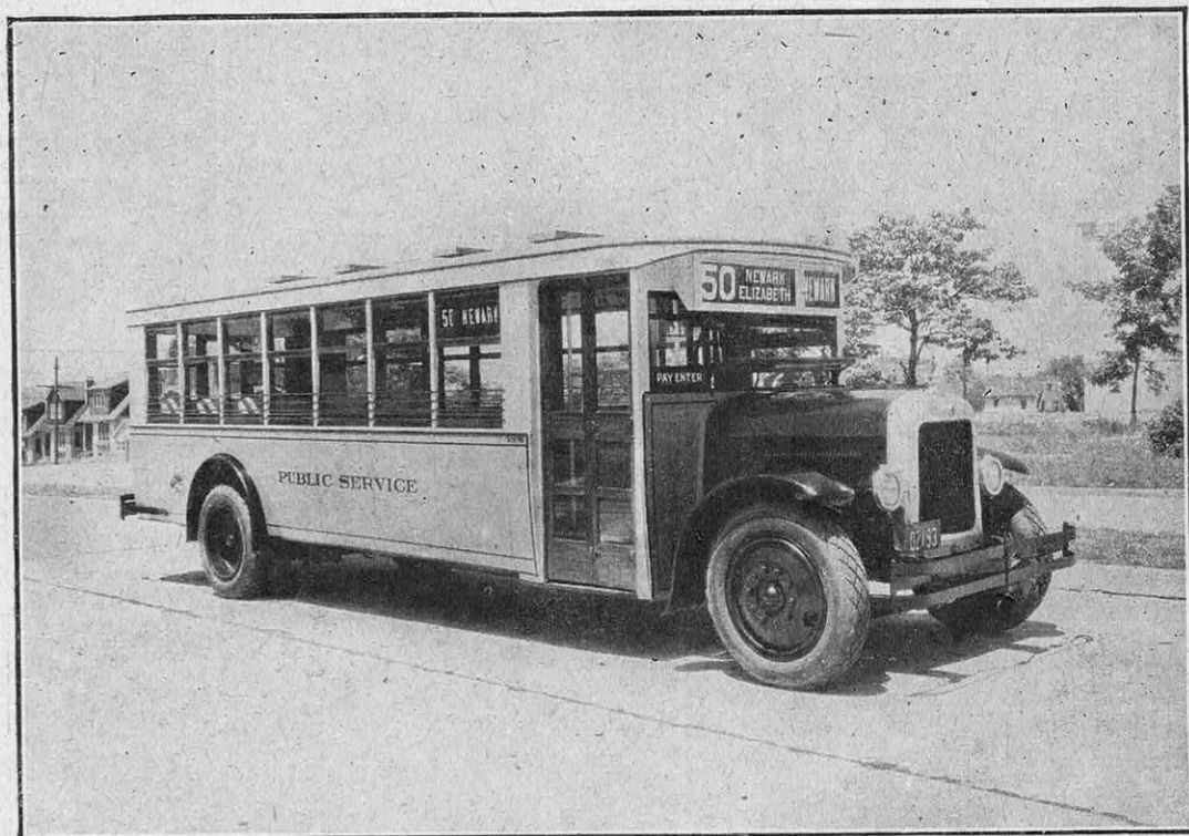
FIG. 4. — AUTOCAR AMÉRICAIN A TRANSMISSION « PÉTROLEO-ÉLECTRIQUE ». LE MOTEUR ENTRAÎNE UNE DYNAMO ALIMENTANT UN MOTEUR ÉLECTRIQUE A L'ARRIÈRE
