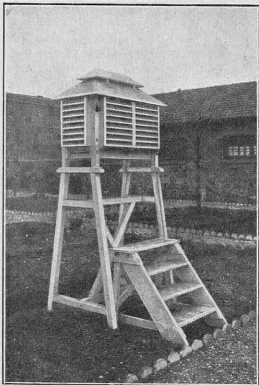
FIG. 8. — ABRI MÉTÉOROLOGIQUE SPÉCIALEMENT AMÉNAGÉ POUR LES PAYS FROIDS Les volets latéraux servent à préserver les appareils météorologiques, contenus dans cet abri, contre la neige.
