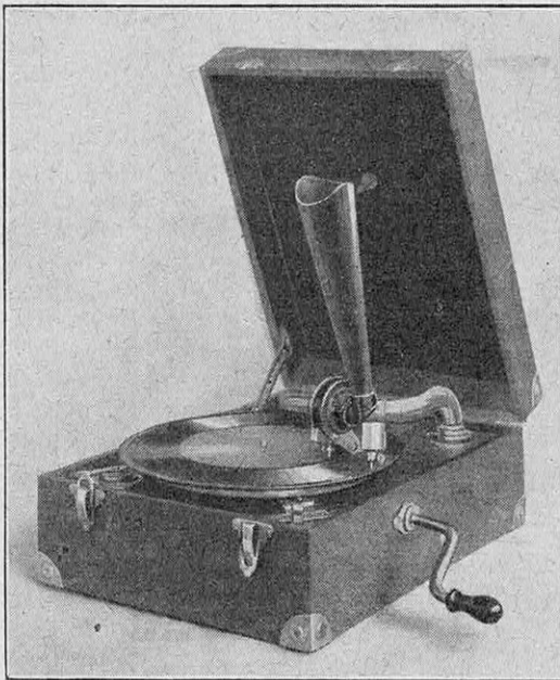
FIG. 9. - ENREGISTREUR COMPLET SANS PICK-UP En parlant dans le cornet, l'aiguille du diaphragme trace les sillons sur le disque en aluminium placé au centre. Le mouvement latéral est obtenu en utilisant un disque ordinaire, sur lequel s'appuie une autre aiguille qui suit les sillons et entraîne le dispositif.
