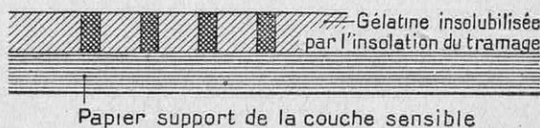
FIG. 12 ET 13. — LE MÉCANISME DU TRAMAGE EN ROTOGRAVURE
