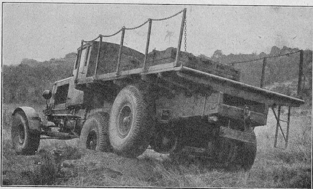
CAMION DE 40 CH A SIX ROUES, DONT QUATRE MOTRICES
