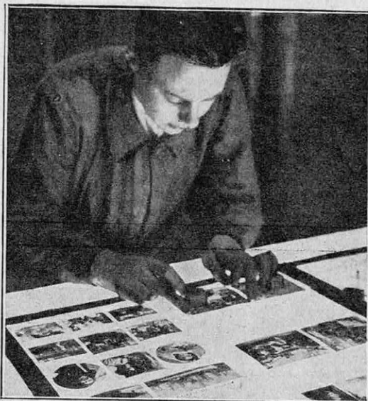
FIG. 6. — LE MONTAGE DE LA FORME LUMINEUSE SUR TABLE DE VERRE
