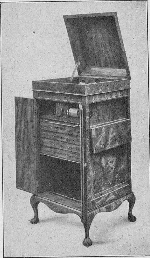
FIG. 2. — VOICI UN ENSEMBLE QUI COMPORTE NON SEULEMENT UN PUISSANT RÉCEPTEUR DE T. S. F. ET UN PHONOGRAPHE A PICK-UP, MAIS ENCORE UN PETIT APPAREIL DE PROJECTION CINÉMATOGRAPHIQUE
