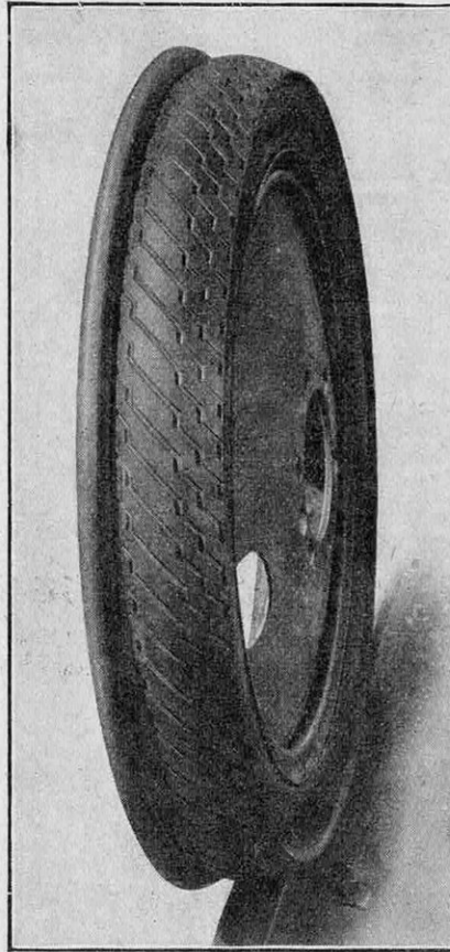
LE PNEUMATIQUE MONTÉ SUR LA ROUE, DISQUE D'ACIER EMBOUTI
