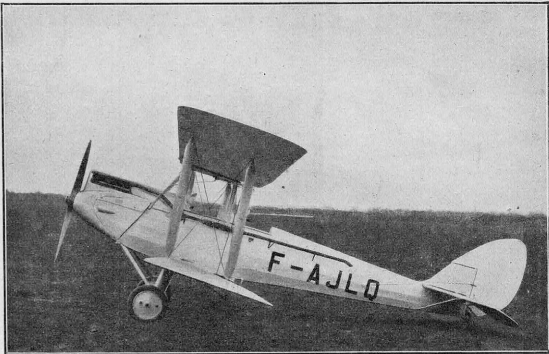
AVION MORANE-SAULNIER « MOTH », ÉQUIPÉ D UN MOTEUR GIPSY 100 CHEVAUX
