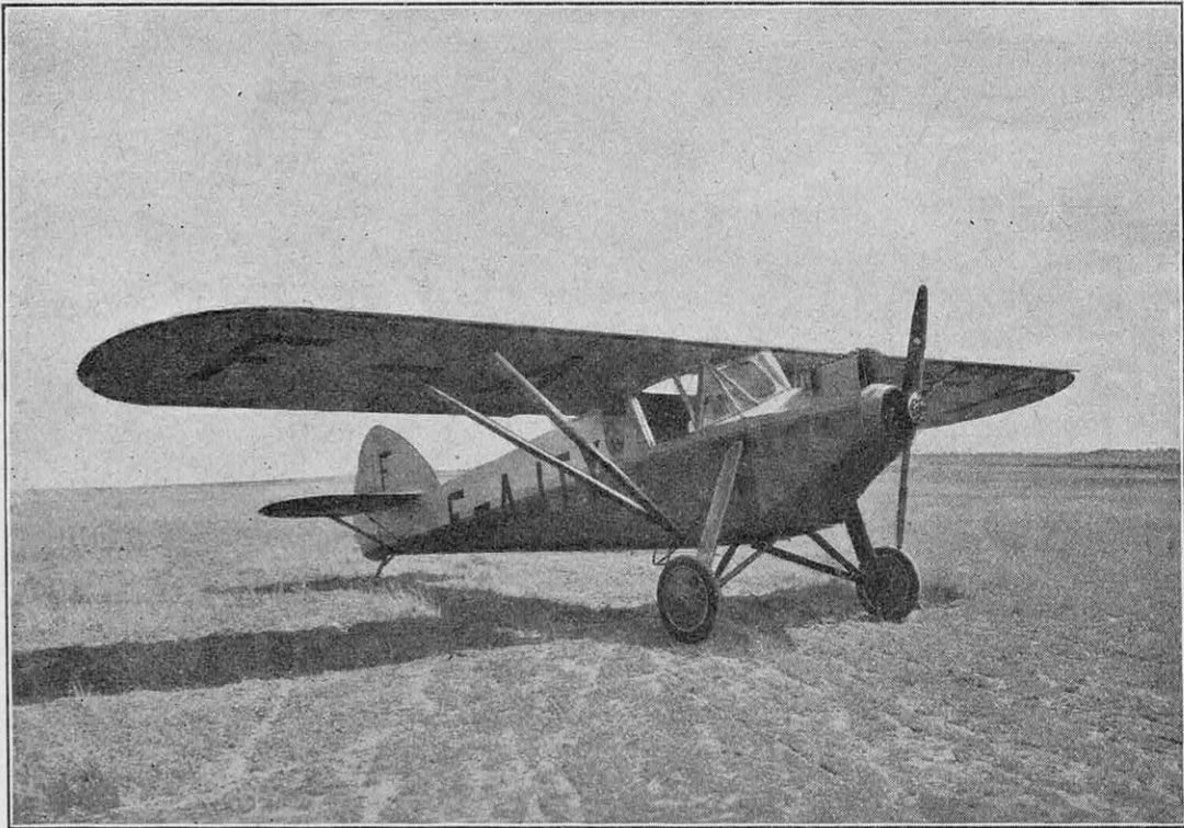
AVION « POTEZ », TYPE 36 ÉQUIPÉ D'UN MOTEUR RENAULT DE 95 CHEVAUX
