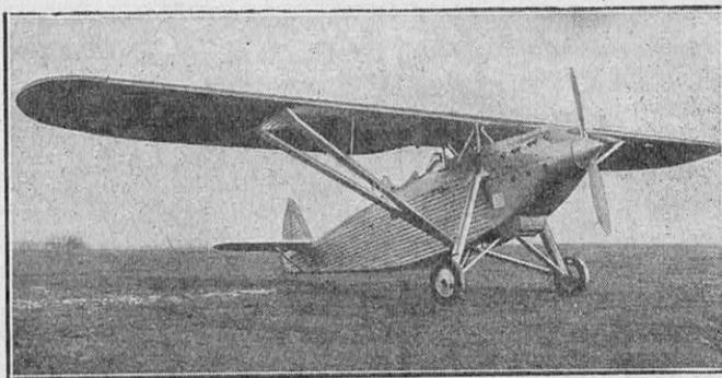
AVION « POTEZ 39-A2 », ENTIÈREMENT MÉTALLIQUE, DONT LA STRUCTURE ET LE REVÊTEMENT DES AILES ET DU FUSELAGE SONT EN DURALUMIN
