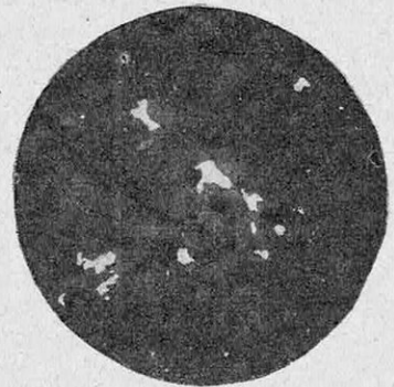
FIG. 2. — OR NATIF DANS UN GNEISS AMPHIBOLIQUE DE MADAGASCAR (AMBALARANO SUR LE BERERE)
