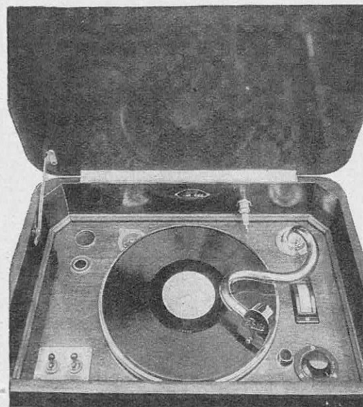
FIG. 4. — LE PLATEAU DU « PANATONAL » A droite, sous le bras du pic'-up, le cadran du milliampèremètre, devant le bouton de réglage de la puissance.
