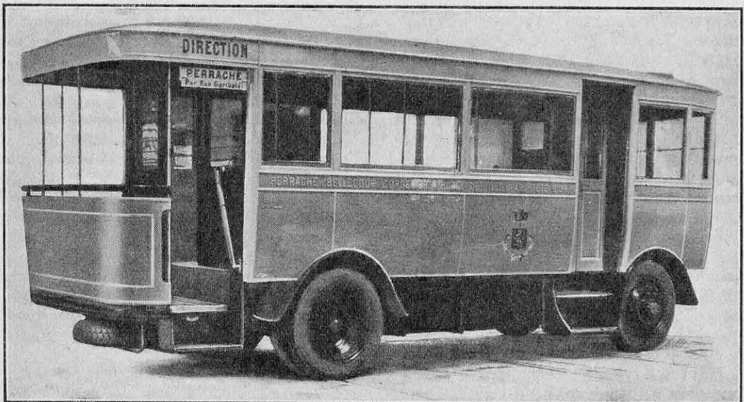
FIG. 2. — L'AUTOBUS A ACCUMULATEURS PEUT AVANTAGEUSEMENT ÊTRE EMPLOYÉ DANS LES VILLES ALIMENTÉES EN ÉNERGIE ÉLECTRIQUE BON MARCHÉ
