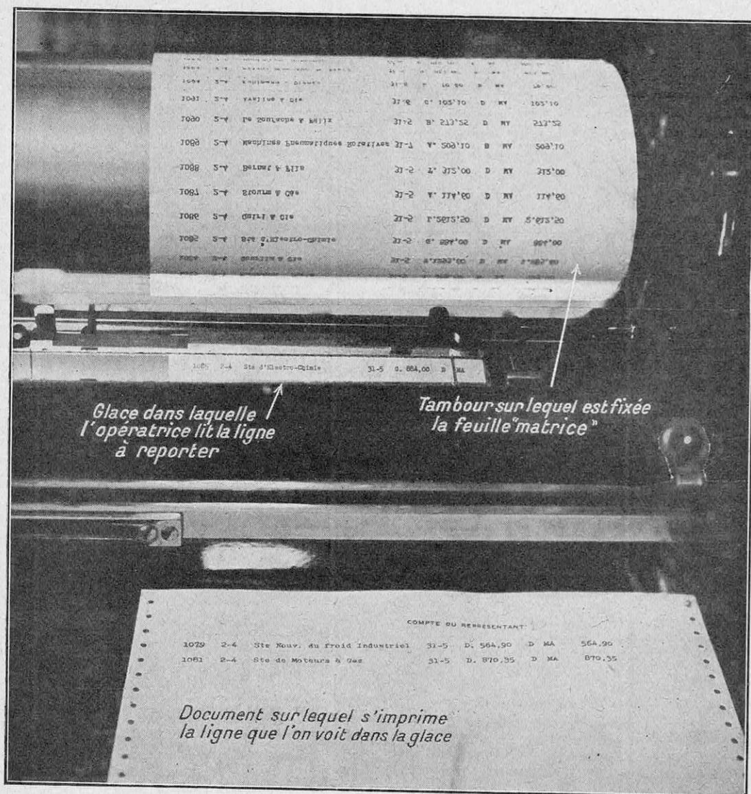
FIG. 3. — DÉTAILS DU SYSTÈME REPRODUCTEUR A LA MACHINE « ORMIG »
