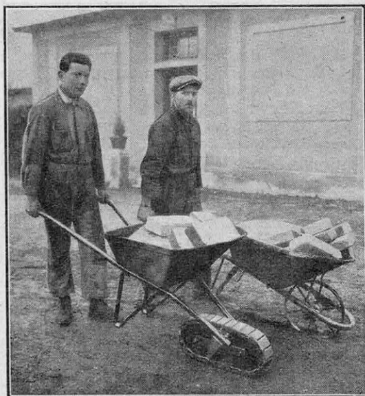
SUR UN TERRAIN MOU, LA ROUE DE LA BROUETTE ORDINAIRE S'ENFONCE, TANDIS QUE LA CHENILLE CIRCULE FACILEMENT
