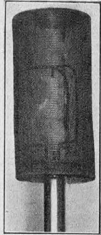
LE FIL CHAUD DANS LA CAGE MÉTALLIQUE DESTINÉE A RÉGULARISER LE SOUFFLE DU VENT (ÉLIMINER LES TOURBILLONS)
