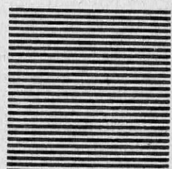
FIG. 8. — Les traits sont deux fois plus rapprochés. L'aspect de teinte plate se produit au delà de 1 m 50. Des traits séparés par un dixième de millimètre ne se distinguent plus au delà de 30 mètres.
