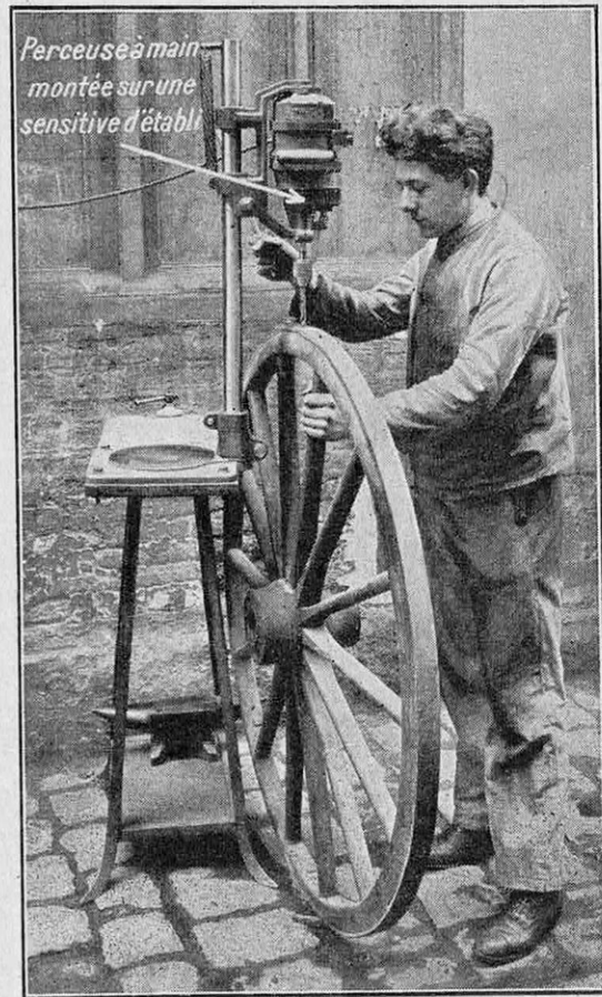
INSTALLATION DE LA PERCEUSE POUR TRAVAUX DE CHARRONNAGE
