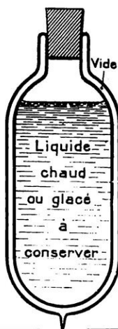
FIG. 6. - LE VIDE NE CONDUIT PAS LA CHALEUR Une « bouteille thermos », à goulot suffisamment étroit, conserve à leur température les liquides chauds ou glacés, car le vide s'oppose aussi bien au passage de la chaleur de l'intérieur vers l'extérieur qu'au passage inverse.
