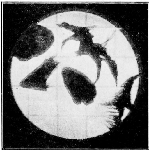
FIG. 3 ET 4. — VUES MICROPHOTOGRAPHIQUES DE DÉCHETS ENLEVÉS PAR L'ÉPOINTEUSE ET LA BROSE, REPRÉSENTÉES SUR LA FIGURE CI-DESSUS
