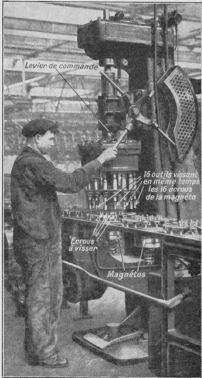
TOUS LES ÉCROUS DE LA MAGNÉTO SONT VISSÉS EN MÊME TEMPS PAR CETTE MACHINE
