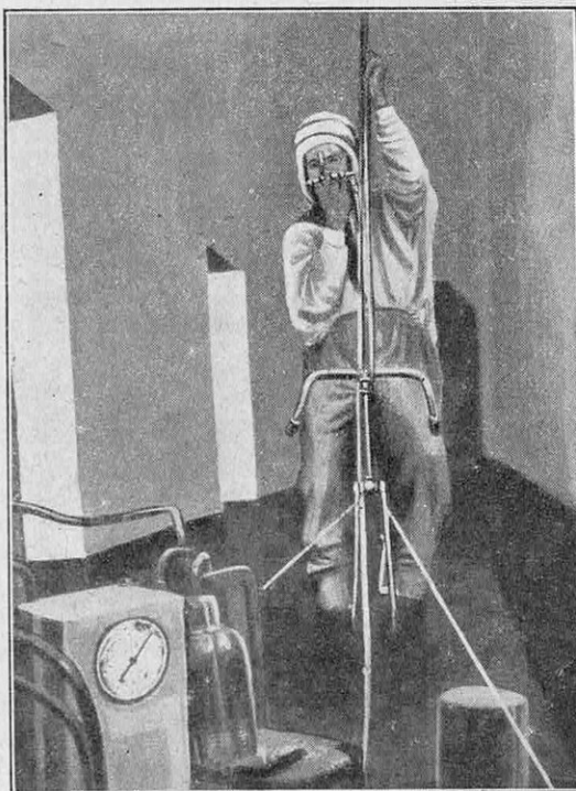
FIG. 7. — LA MACHINE A MESURER LE RENDEMENT DU MOTEUR HUMAIN
