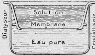
FIG. 2. — COUPE D'UN DIALYSEUR
