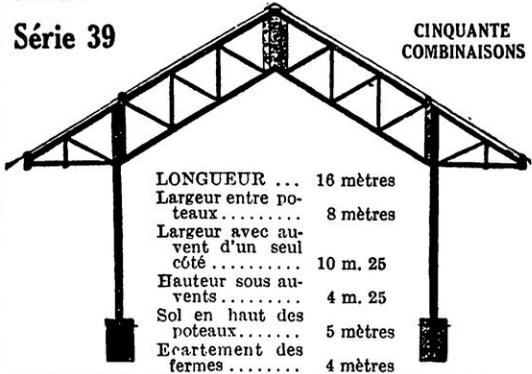
Toiture : tôle ondulée galvanisée, posée sur des pannes en sapin du Nord.
