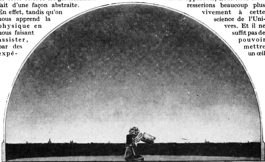
INSTALLÉ AU CENTRE D'UNE DEMI-SPHÈRE DE 10 MÈTRES DE DIAMÈTRE, L'APPAREIL CI-DESSUS PROJETTE À L'INTÉRIEUR DE CETTE COUPOLE TOUTES LES CONSTELLATIONS, LES PLANÈTES, LE SOLEIL, LA LUNE, AVEC LEURS MOUVEMENTS RESPECTIFS
