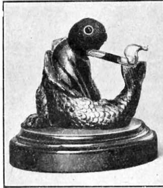
SELON LE DEGRÉ D'HUMIDITÉ D'UNE PIÈCE ET SON AÉRATION, LE LIQUIDE CONTENU DANS LE TUBE PREND UN MOUVEMENT DE VA-ET-VIENT PLUS OU MOINS RAPIDE
