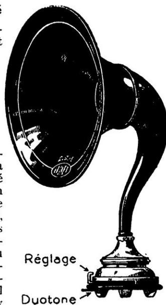
donnant naissance à un champ magnétique variable qui vient modifier la valeur du champ constant créé par un fort aimant placé devant la membrane. Les variations du flux total, proportionnelles à l'amplitude du courant modulé, agissent alors sur cette membrane dont les vibrations sont transmises à l'air environnant, rendant ainsi audibles les variations du courant capté par le récepteur.
