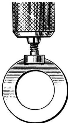
FIG. 6. — OUTIL POUR PERCER DES TROUS DE GRAND DIAMÈTRE DANS L'ÉBONITE
