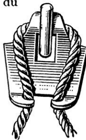
CET APPAREIL EMPÊCHE TOUT GLISSEMENT DU CORDON SOUTENANT LE TABLEAU
