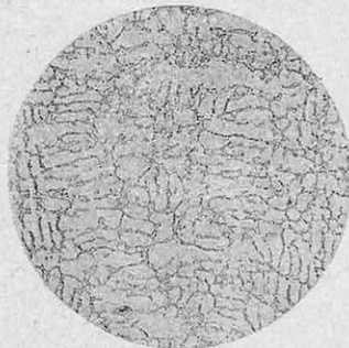
ALLIAGE ALUMINIUM-CUIVRE (CUIVRE : 14 %) POUR PISTONS DE MOTEURS (GROSSISSEMENT FAIBLE)
